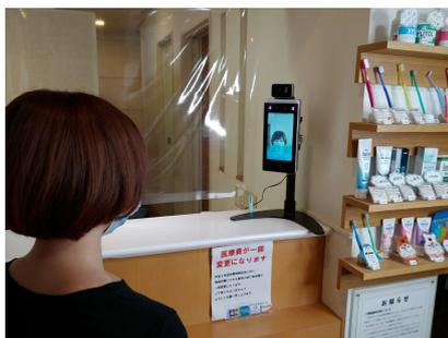
AI（人工知能）により、温度測定誤差は±0.5°Cと高い精度での体温測定ができます。
